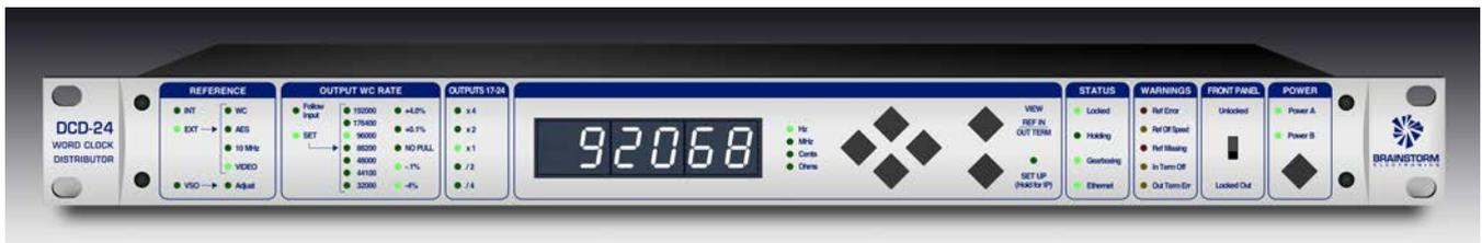
DCD-24は、ワードクロックジェネレータとディストリビュータの両方を兼ね備えています。並はずれたジッタ低減技術を使用し、DCD-24には24個のBNC出力を持ち、各機器へ正確なワードクロックを供給します。
